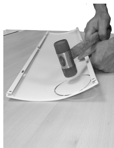
Fig. 38 - Åben hullet (Sfera 3 Plus model)
