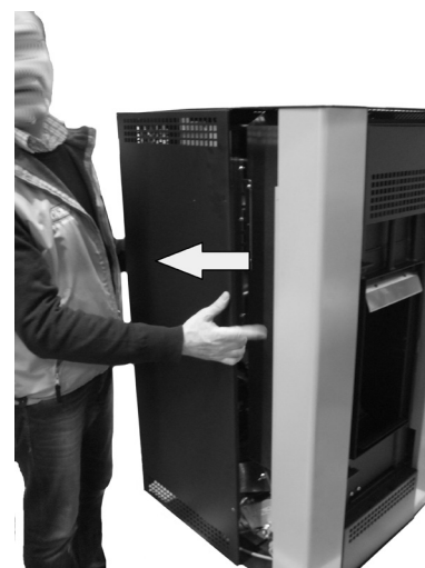
Fig. 95 - Fjernelse af sidestykker
