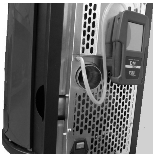
Fig. 55 - Tilslutning af digital trykmåler
