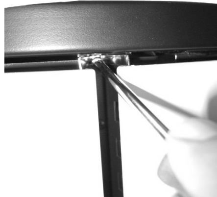
Fig. 40 - Skru holderen
