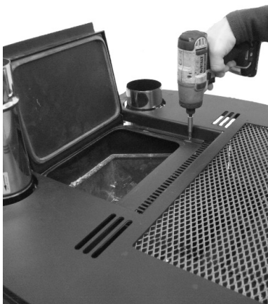
Fig. 41 - Fjern skruerne ovenpå
