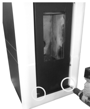
Fig. 32 - Fastgøring af ramme
