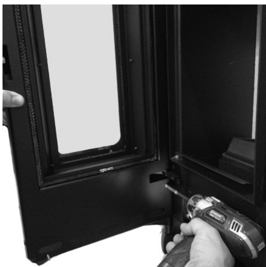
Fig. 85 - Skruernes løsning
